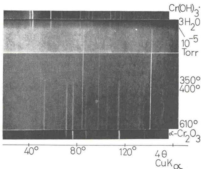
Fig. 5. Pulver-Röntgendiagramme zur Thermolyse von kristallinem Chrom(III)hydroxid in Vakuum,  $\text{CuK}\alpha$ -Strahlung. Drei durchlaufende Reflexe stammen von Pt-Objektträger. Zuunterst: Zum Vergleich  $\alpha\text{-Cr}_2\text{O}_3$ . Zuoberst: Zum Vergleich das Ausgangsprodukt.
